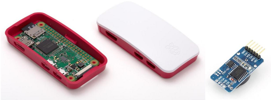
9. ábra: Raspberry Pi Zero W és Valósidejű óra modul
