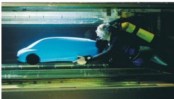
2. ábra: gépkocsi modell tesztelése vízcsatornában
